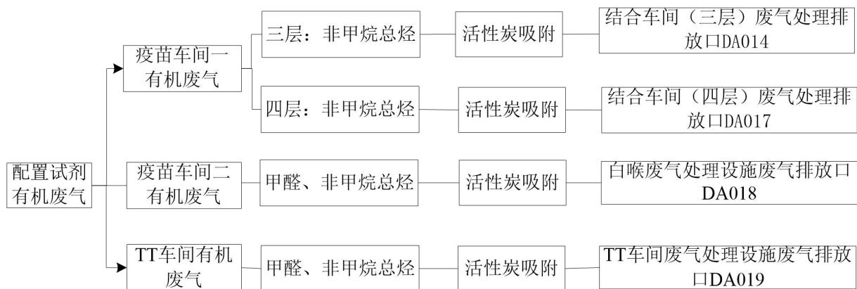
图4-2 配置试剂有机废气收集处理排放示意图
