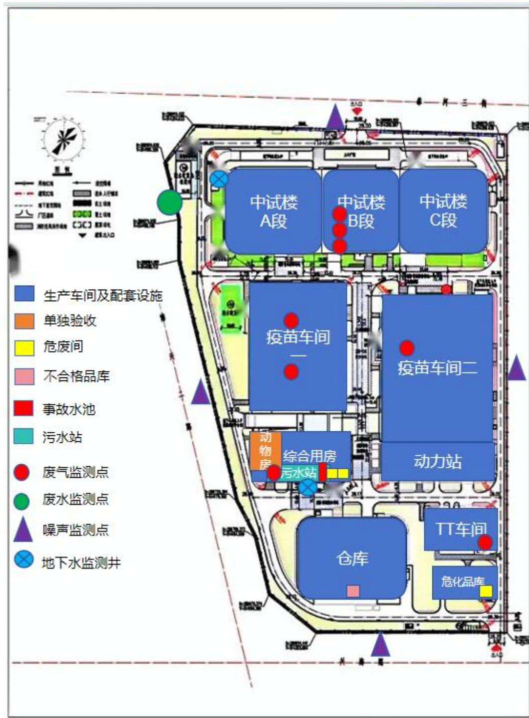
图7-1 项目污染源监测点位示意图（无组织监测上风向1个、下风向3个，位置据实）
